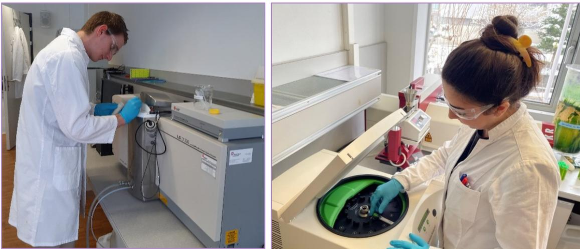
Abbildung 16 Messung einer PGV an der HSLU: Links Laserbeugung, rechts optische Zentrifuge.
