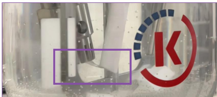
**Abbildung 7** Laborgerät: Die Ölphase wird über einen Zulauf (weisses Rohr) direkt auf den Homogenisator gegeben.
