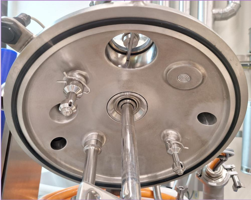
Abbildung 10 Foto eines sauberen Deckels nach einer ordentlichen Reinigung.
